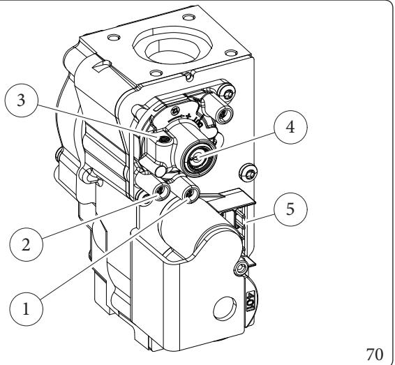
**⚠ Po 10 letech od data výroby plynový ventil vyměňte.**
